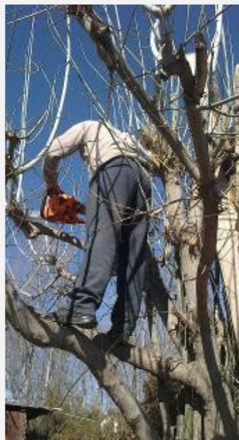
Foto 2: Trabajos en altura con máquinas herramienta manual: Sin EPP c/peligro de caída a desnivel y cercenamiento por rebote o contacto con cadena de motosierra
